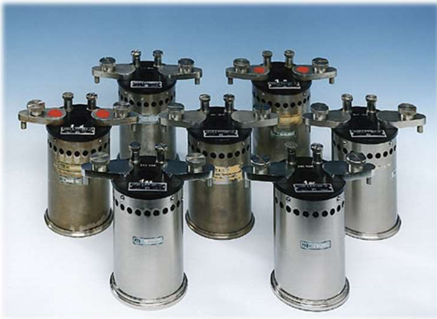
Quanten-Hall Referenzwiderstände (Quelle: PTB Braunschweig)
