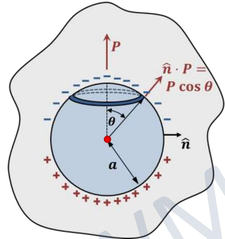
Allgemeines Theorem der Elektrodynamik: elektrische Feld eines homogen polarisierten Festkörpers entspricht dem Vakuumfeld einer effektiven Flächenladungsdichte  $\rho_P$  auf seiner Oberfläche
