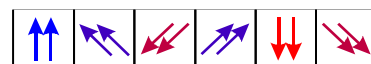
Bild 8.17: Verschwindende globale spontane Magnetisierung durch statistische Verteilung von Clustern mit ausgerichteten Spins
