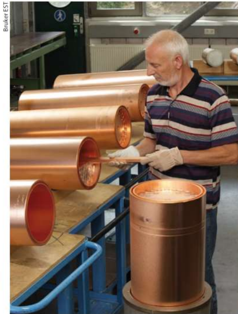
Von Hand werden bei Bruker EST in Hanau Stangen aus NbTi und Kupferrohre gebündelt. Daraus entstehen dünne supra-leitende Drähte, die zahlreiche NbTi-Filamente in einer Kupfermatrix enthalten (links).
