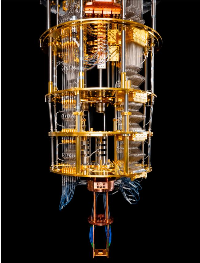
Abbildung 1 – Kryostat zum Betrieb von supraleitenden Quantenprozessoren bei tiefen Temperaturen. © Mikka Stampa/MQV.
