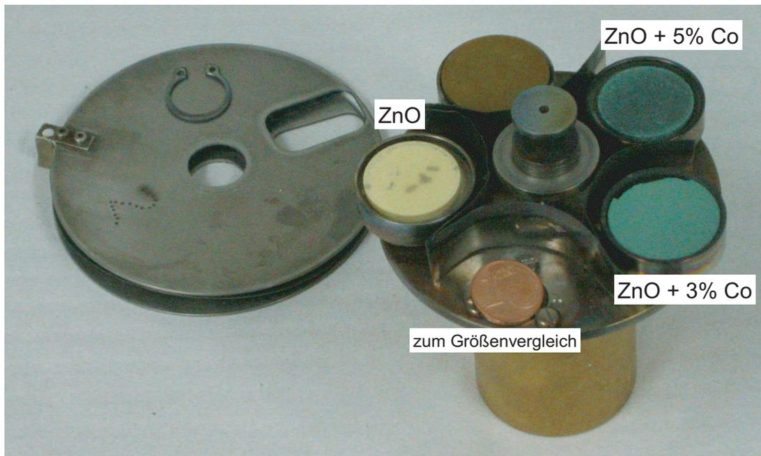
Abb. 3.3: PLD-Targetkarussell mit  $\text{ZnO}$ -Targets verschiedenen Dotierungsgrades.
