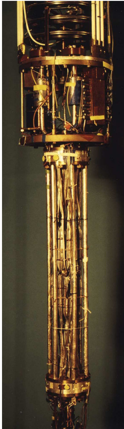
Abbildung 4.4: Foto der \text{PrNi}_5 -Kernstufe der „Bayerischen Millimühle 2“. Im unteren Bildteil ist die Kernstufe mit den \text{PrNi}_5 -Stäben zu sehen. Das oberste sichtbare Niveau ist die Mischkammer, dazwischen sieht man die beiden Wärmeschalter. Die Zelle befindet sich ganz unten ausserhalb des Bildes.
