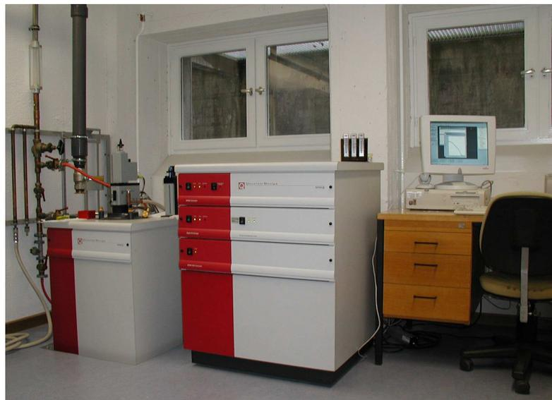
Abbildung 3.7: Quantum Design SQUID-Magnetometer.
