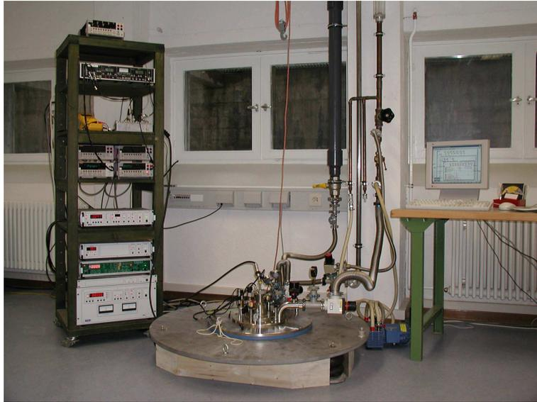
Abbildung 3.5: Oxford Magnetkryostat im Boden versenkt auf Luftfedern mit Messelektronik.
