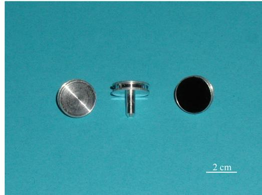
**Abbildung 3.15:** Stifträger mit einem Durchmesser von 0.5 Zoll, wie sie in der Rasterelektronenmikroskopie häufig verwendet werden. Sie verfügen über Nut, in die eine speziell geformte Pinzette zur besseren Handhabung beim Ein- und Ausbau greifen kann. Der Stifträger rechts ist mit einem Leittab bestückt, das eine Probe elektrisch leitend fixieren kann.
