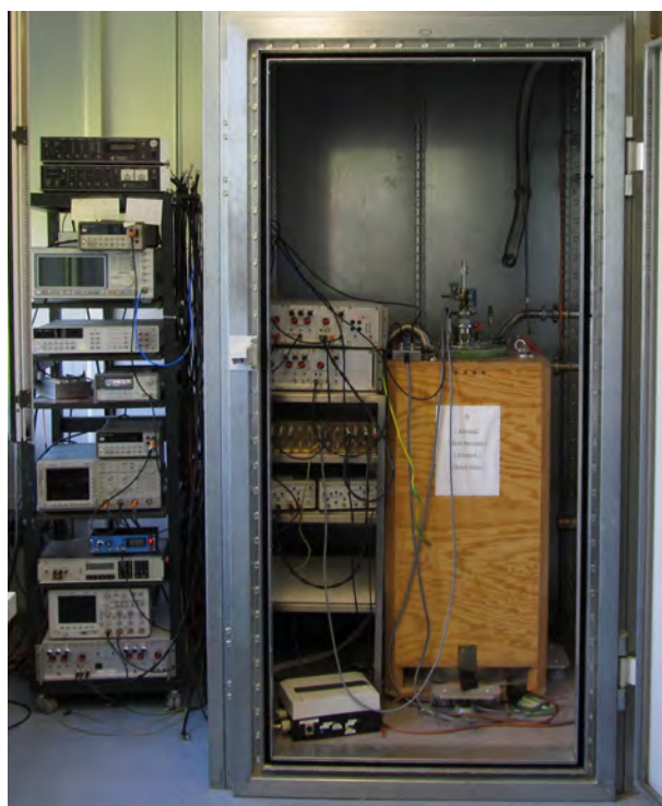
Abbildung 34: Messaufbau für 4,2K-Messungen. Unter der Holzverkleidung befindet sich ein Dewar, in das ^4\text{He} einkondensiert werden kann. Links neben der Holzverkleidung sieht man batteriebetriebene Messgeräten. Die Computergestützte Auslese- und Ansteuerungselektronik befindet sich links außerhalb der Abschirmkammer.
