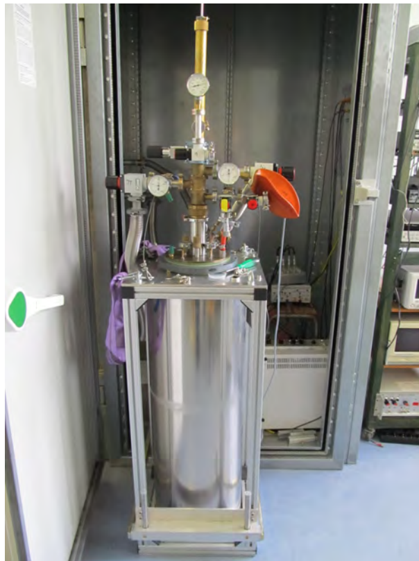
Abbildung 37: Foto des 500 mK-Kryostaten. Im Hintergrund sieht man die Abschirmkammer, in die der Kryostat für Messungen verbracht wird
