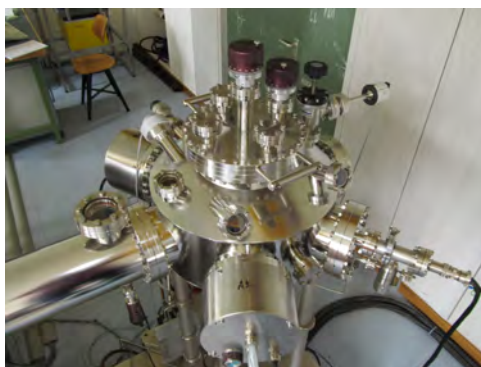
Abbildung 60: Niob/Aluminium Aufdampfanlage mit Ion Gun
