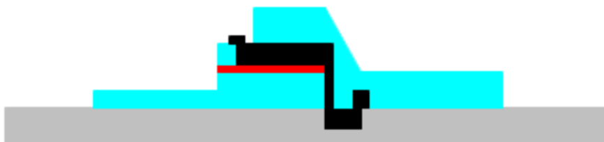
Abbildung 19: Schema eines Nb/Al – AlO x /SiO x /Nb-Übergang, der zur Überprüfung der SiO x -Schicht hergestellt wurde. Die so hergestellten Proben wiesen sehr hohe Widerstände auf.
