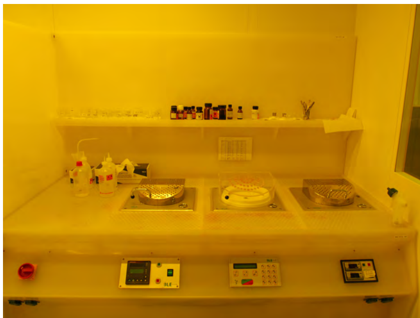
Abbildung 59: Eine Arbeitsbank im Reinraum. In der Mitte ist die Lackschleuder zu sehen, links und rechts davon zwei kleine abdeckbare Herdplatten
